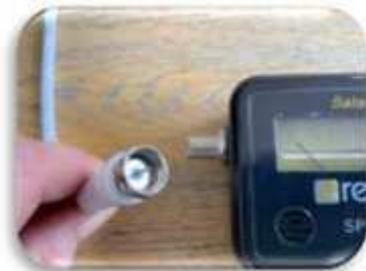
Connectez le deuxième câble coaxial au détecteur de satellite sur le côté étiqueté Récepteur/Power.
