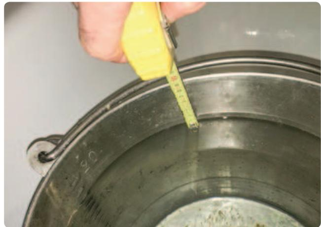
ABB. 2 Messung des Wasserstands zur Ermittlung des Wasservolumens
