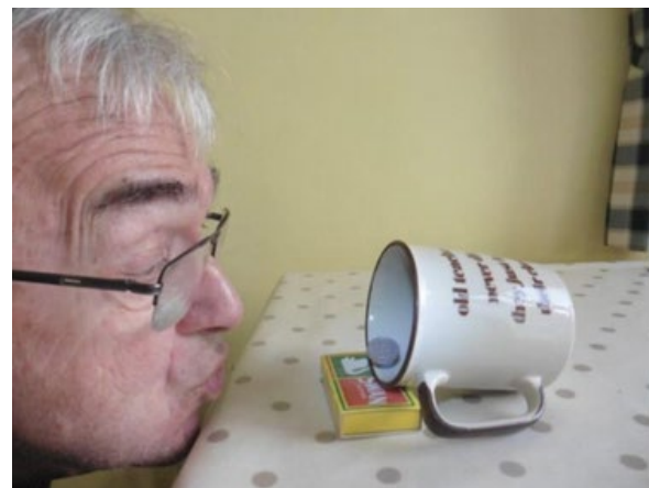
Photo 2 : La pièce est soulevée dans la tasse par la réduction de la pression de l'air au-dessus d'elle.
